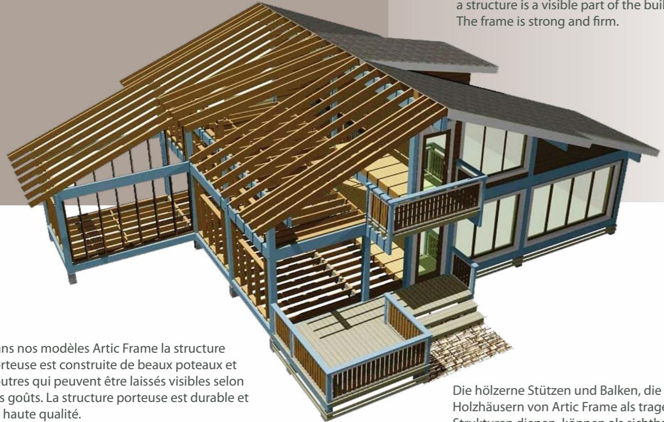
Dans nos modèles Artic Frame la structure porteuse est construite de beaux poteaux et poutres qui peuvent être laissés visibles selon vos goûts. La structure porteuse est durable et de haute qualité.
